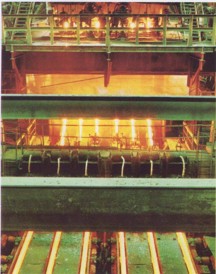
Сортовая шестиручьева машина непрерывного литья заготовок производительностью 700 тысяч тонн в год. Изготовлена ЮУМЗ для Молдавского металлургического завода
